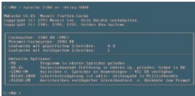
Bild 1: Angstphase: Novells Cache bietet verzögertes Schreiben nur für Festplatten an. Beim Kopieren auf Diskette können Sie erst weiterarbeiten, wenn der Cache fertig ist.
