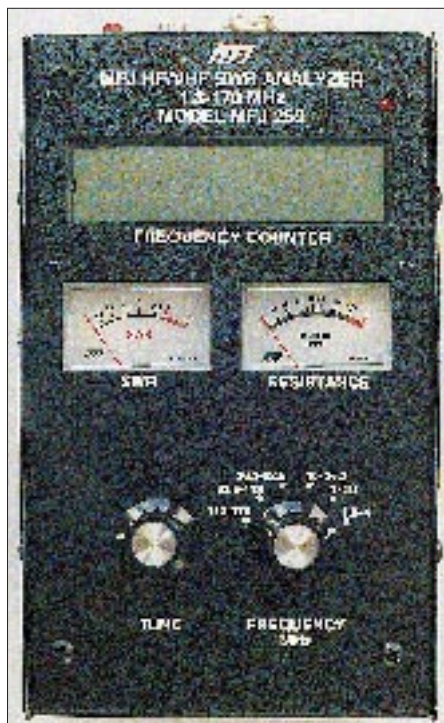
Bild 1: Frontansicht. Oben das LC-Display, darunter die Meßinstrumente für SWR und Widerstand. Links un-ten die Frequenzeinstellung, rechts der Bereichsschalter. Oben rechts oberhalb des Displays die LED für die Anzeige der Toröffnung. Die SWR-Anzeige hat s = 2 in der Mitte der Skale, oberhalb von s = 3 gibt es keine Skalierung mehr. Die Widerstandsskale zeigt zunehmende Stauchung oberhalb 100 Ω. Die Instrumente sind nicht beleuchtet, erzeugen jedoch einen hintergrundbeleuchteten Effekt.
