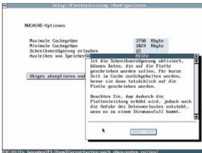
Bild 2: Einige Cache-Parameter können Sie bei Novell Cache auch über das Setup-Programm einstellen.
