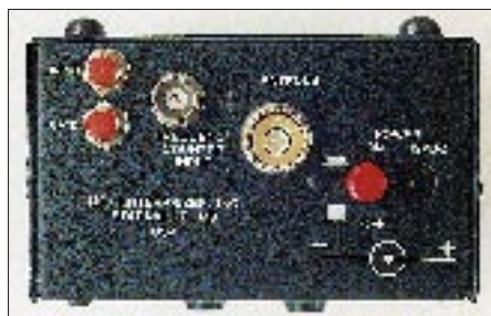
Bild 2: Blick auf die Oberseite. Oben links die Drucktaste Input (nichtrastend) zum Durchschalten der Buchse Frequency Counter Input auf den Zähler. Die Drucktaste Gate (nichtrastend) ermöglicht die Wahl der Torzeiten des Zählers. Mittig die Buchse SO-239 für das Meßobjekt. Rechts davon der rastende Taster Power und die Betriebsspannungsbuchse (Stift 2,1 mm).
